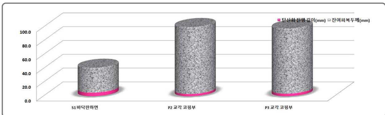
[그림 10.3.5] 탄산화깊이 및 잔여피복두께 측정결과
